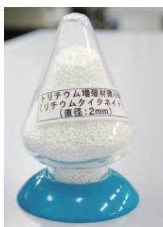
写真① 核融合炉で使用されているトリチウム増殖材料
